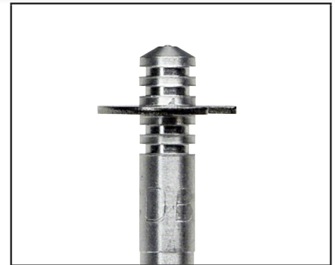
Положение С-образной шайбы на игле определяет качество смеси на средних оборотах
